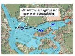
gering, um ein HQ100 ausuferungsfrei abzuführen. Hier ist ein Neubau der Brücke mit einem größeren Brückenunumgänglich querschnitt Kreis). Des Weiteren sind Hochwasserschutzmauern im Bereich Stabhalterhof mit einer Länge 44 mtr. und geschätzt 0,5 mtr. Höhe auf der linken Seite bachaufwärts und im Bereich Stabhalterbrücke bachaufwärts auf der rechten Seite vor dem Anwesen Talstrasse 3 mit 33 mtr. bei einer Höhe von geschätzt 0,9 mtr. und nach dem Anwesen Talstrasse 3 bis
