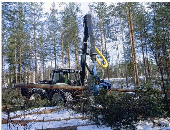
**Bildunterschrift:** Dort wo es möglich ist, sollte Sturmholz mit forstlichen Großmaschinen, wie zum Beispiel einem Harvester, sicher aufgearbeitet werden. Foto: SVLFG
