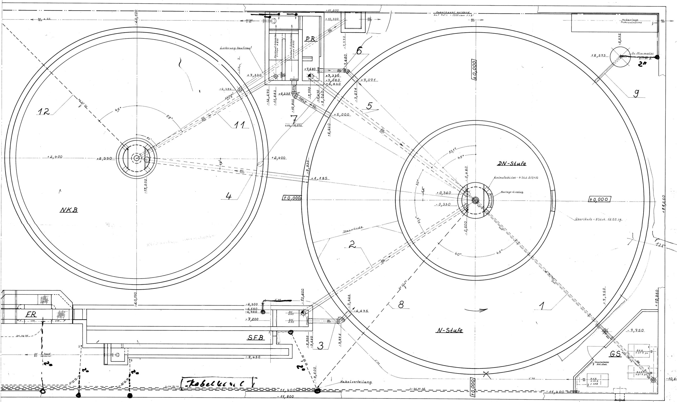
Alle Rohre sind in Magerbeton zu verlegen mit seitlicher Betonüberdeckung von 10 cm!
